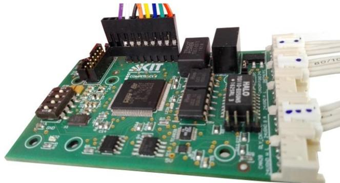
Masterboard des Batterietechnikum-BMS mit STM32-Microcontroller
